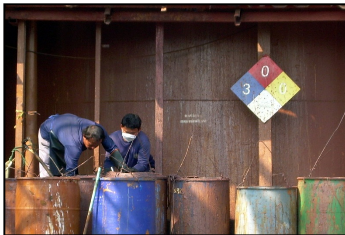
ภาพที่ 2 ตัวอย่างสัญลักษณ์ตามระบบ NFPA 704 ที่อาจพบได้ในชีวิตประจำวัน
