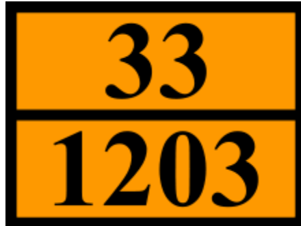
ภาพที่ 3 ตัวอย่างแผ่นป้ายสีส้มตามระบบ ADR ที่พบได้ข้างรถบรรทุกสารเคมี
